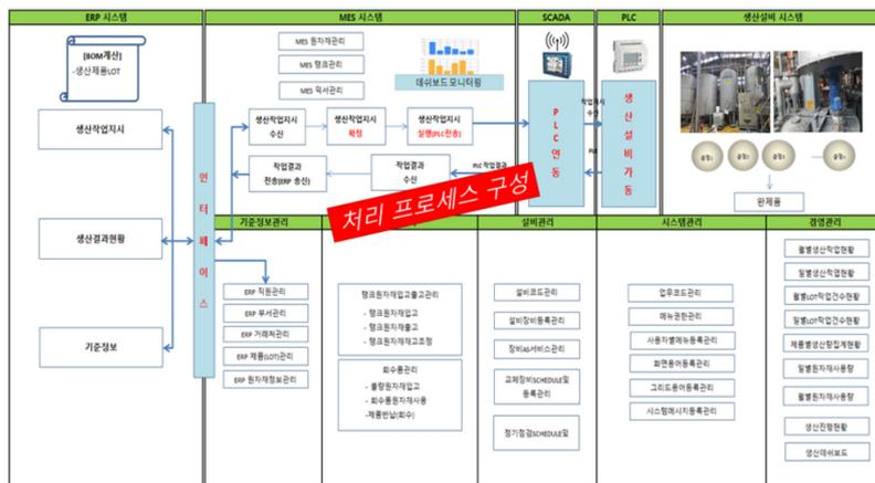
ERP, MES, SCADA, PLC, 생산설비 시스템이 연동된 스마트팩토리 처리 프로세스 구축사례입니다. ERP에서 수립된 생산계획과 기준정보는 MES로 전달되어 작업 지시와 실적 수집이 이루어지고, SCADA와 PLC를 통해 생산설비의 데이터를 실시간으로 수집 및 제어함으로써 생산 현장의 자동화와 실시간 모니터링이 가능한 통합 운영 환경을 구현하였습니다.
